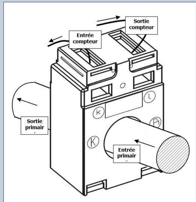
Un transformateur de courant a un sens de branchement. Il ne faut jamais laisser le secondaire d'un transformateur de courant ouvert.
